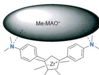
**Unverbrückte, jedoch isospezifische Metallocenkatalysatoren** zur Polypropylenherstellung lassen sich während eines Methylaluminoxan(MAO)-unterstützten Aktivierungsschrittes *in situ* erzeugen (siehe Bild). Dies wird an einem Dimethylaminophenyl-substituierten Zirconocen demonstriert, das im festen Zustand eine racemische,  $C_2$ -symmetrische Struktur aufweist und hoch isotaktisches Polypropylen ergibt.
